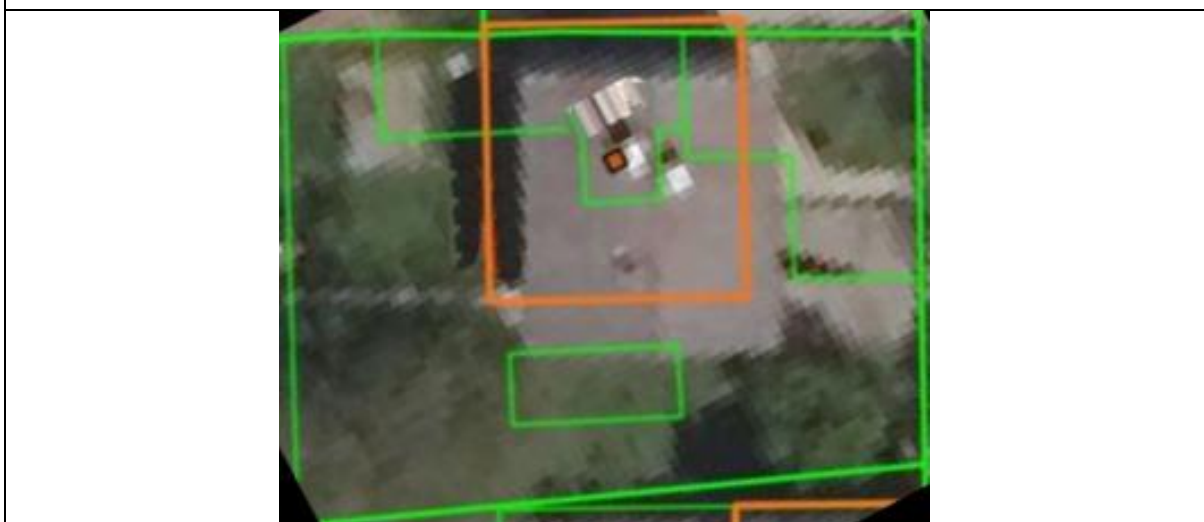
Slika 3 – primer, kjer je v zemljiškem katastru evidentirano še predhodno stanje stavb (3 zeleni obrisi stavb), v naravi pa je ena nova stavba, katere obris je v registru nepremičnin (oranžno) → lastnik pri geodetskem podjetju naroči elaborat za evidentiranje stavbe.
