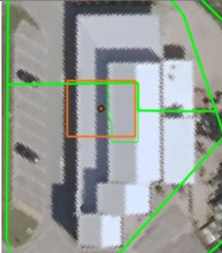
Slika 4 – primer, kjer je v zemljiškem katastru in registru nepremičnin evidentirano še predhodno stanje stavbe, v naravi pa je nova, bistveno večja poslovna stavba → lastnik pri geodetskem podjetju naroči elaborat za evidentiranje stavbe in ureditev parcelnega stanja.
