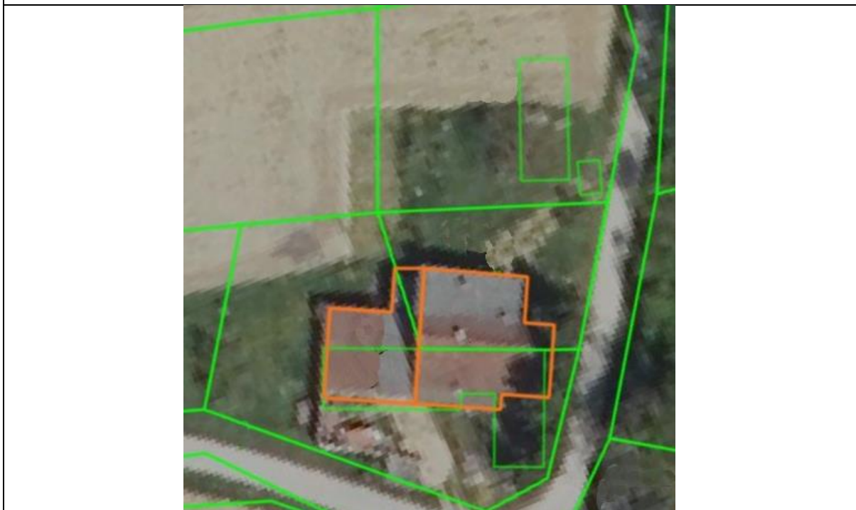
Slika 7 – primer porušениh stavb na severni parceli, ki so še evidentirane v zemljiškem katastru, in dograjenih stavb na južni parceli, ki niso evidentirane v zemljiškem katastru → lastnik pri geodetskem podjetju naroči elaborat za evidentiranje stavbe in ureditev parcelnega stanja, hkrati se iz katastra izbrišejo porušene stavbe.
