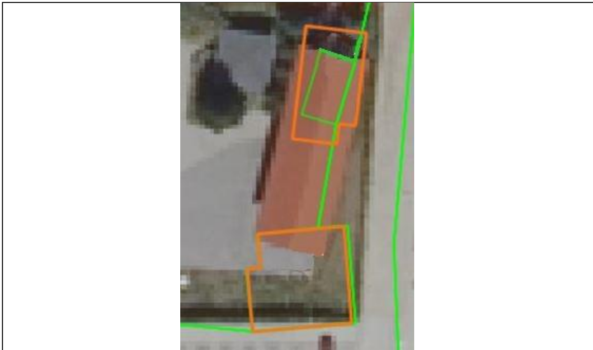
Slika 6 – primer neskladnega stanja, kjer so evidentirane stare stavbe na parceli, novi stavbi pa nista evidentirani → lastnik pri geodetskem podjetju naroči elaborat za evidentiranje stavb, hkrati se iz katastra in registra nepremičnin izbrišeta porušeni stavbi.
